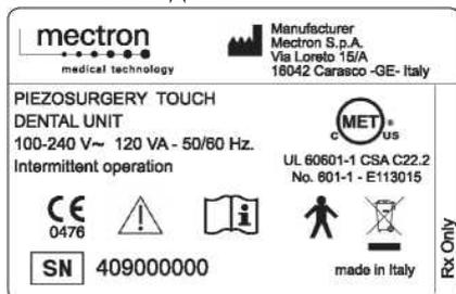
На каждом устройстве есть идентификационная заводская табличка, которая содержит серийный номер и все основные технические характеристики устройства. Заводская идентификационная табличка расположена на нижней панели устройства. Дополнительные технические характеристики устройства приводятся в настоящей инструкции (см. раздел 08 - ТЕХНИЧЕСКИЕ ХАРАКТЕРИСТИКИ).
